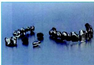
Fräsbeispiele in Kobalt-Chrom mit optimalen Oberflächen ohne Nacharbeit
